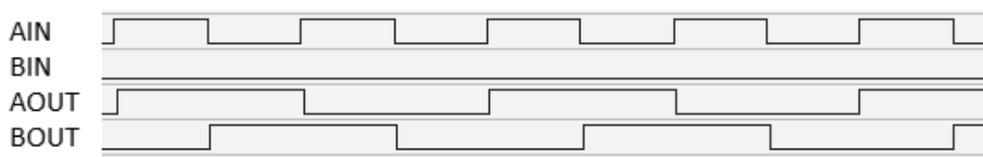
Findet ein Wechsel am BIN Eingangssignal (A/B Dir) statt, so ändert sich die Richtung des A/B 90° Signals am Ausgang. Hier ist eine Teilung um **1:2**, vom Eingang in Bezug auf den Ausgang vorhanden.
