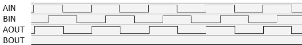
Ändert sich die Richtung des A/B 90° Signals am Eingang, so findet ein Wechsel am BOUT Ausgangssignal statt. (A/B Dir). Es tritt keine Teilung auf.
