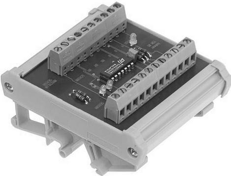
Dieses Interfacemodul erzeugt aus den zwei um 90° phasenverschobenen Ausgangssignalen A, B eines Inkrementalgebers zwei zusätzliche statische Drehrichtungssignale (V, R). Diese Signale können dann zur weiteren Verarbeitung an eine nachfolgende Steuerung übergeben werden.
