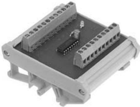
Dieses Interfacemodul dient zur Umsetzung von 5V TTL Inkrementalgebersignalen auf RS 422/485 - Ausgangssignale.
